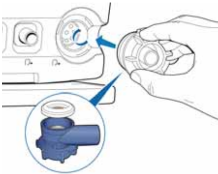
Figura 2-3 Instalação da válvula expiratória
