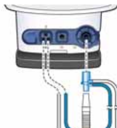
Figura 5-7 Conectar o sensor fluxo à válvula expiratória, modo nCPAP-PS
